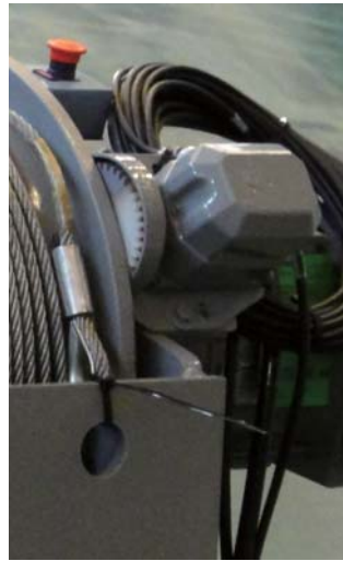
Limit switch «Trolley out» and «Trolley in»
